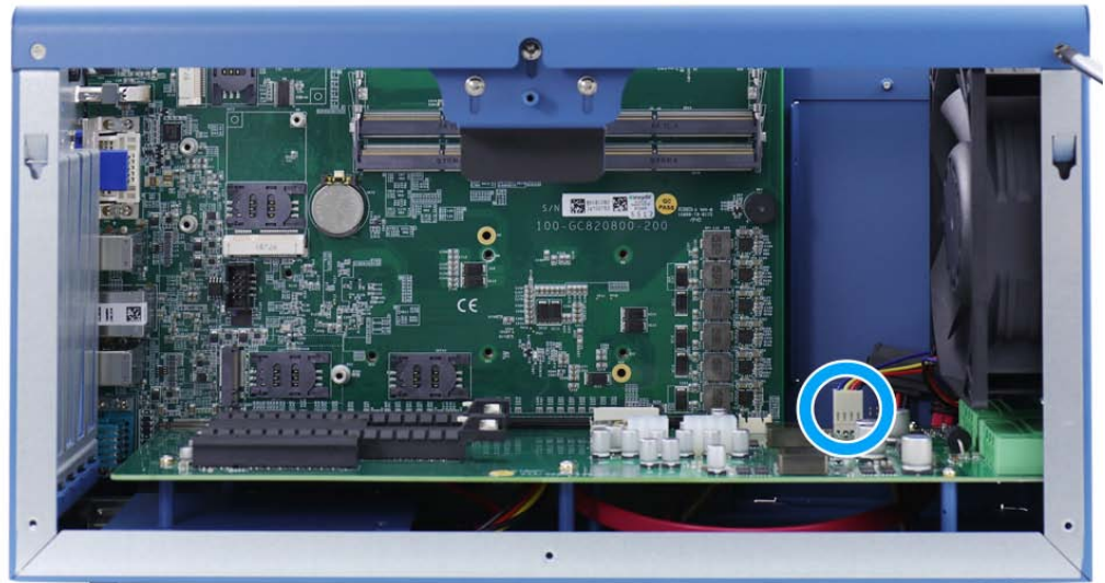
Remove 4-pin fan connector
